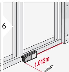
Déplacer l'appareil lentement le long de la ligne d'implantation. La distance jusqu'au jalon suivant s'affiche.
